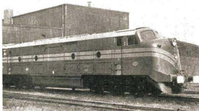
Bild 5 Co'Co'-1900-PS-diesel-elektrische Lokomotive Type KK, gebaut von Henschel (1955)
