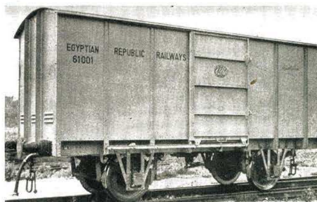
Bild 9 Zweiachsiger Ganz-Stahl-Güterwagen mit außenliegenden Achshaltern, gebaut vom VEB Waggonbau Niesky
