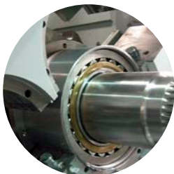
3. Geteilter Maschinenrahmen Einfacher und schneller Austausch kompletter Wellen dank verschraubter Konstruktion
