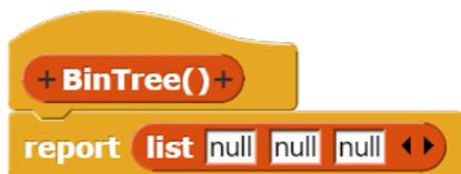
Abbildung 7.5.: Konstruktor für einen leeren Baum
