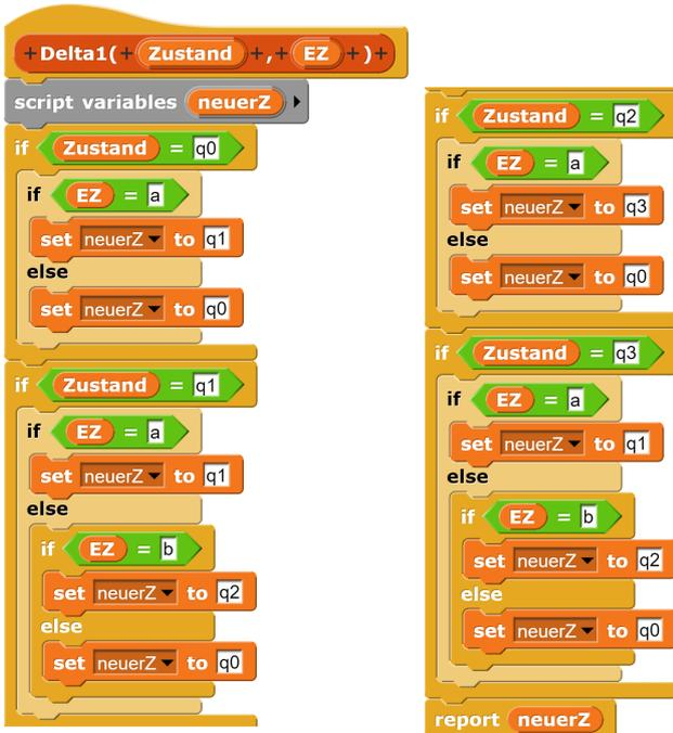
Abbildung 5.9.: Überföhrungsfunktion als geschachtelte Schleife
