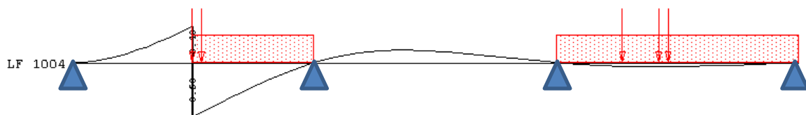
Abbildung 1: Einflusslinie für eine Querkraft im ersten Feld mit schwedischem Lastenzug
