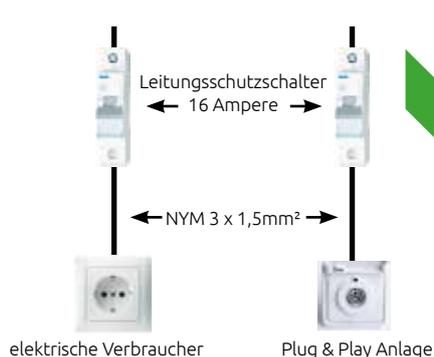
Die beste Variante einen sicheren Anschluss zu gewährleisten ist ein separater Leitungsschutzschalter an der nächst gelegenen Unterverteilung für die Steckdose der Erzeugungsanlage. Der Vorteil an dieser Verschaltung liegt darin, dass die Erzeugungsanlage einzeln abgeschaltet werden kann und nach wie vor auch große Verbraucher an den vorhandenen Steckdosenkreis angeschlossen werden können.
