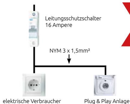
In der Regel sind mehrere Steckdosen bzw. Lampen über einen Leitungsschutzschalter (LSS) abgesichert, der bei Überlastung (Leistungsabnahme größer 3,68 kW) die NYM-Leitung vor Überhitzung schützt. Wenn im selben Steckdosenkreis eine Erzeugungsanlage angeschlossen wäre, könnten einzelne Kabelabschnitte unzulässig überlastet werden, ohne dass der LSS auslöst, da nur noch ein Teil der Leistung über den LSS bereitgestellt wird.
