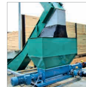
Beschickung der Pumpe über einen Übergabetrichter
