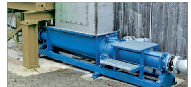
Feststoffeintrag nach Zerkleinerer
