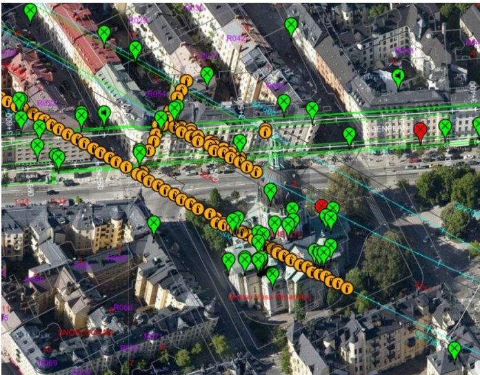
Bild 8: Messtechnische Überwachung im Bereich der Gustav Vasa Kirche: Messpunkte (grün) und Sprengungen (gelb).
