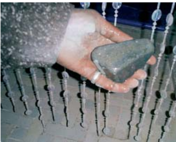
Das wichtigste Werkzeug sowohl für Berber als auch für Schweizer Verarbeiter ist der Polierstein. Am besten eignen sich Halbedelsteine oder Steine aus Basalt oder Achat.
