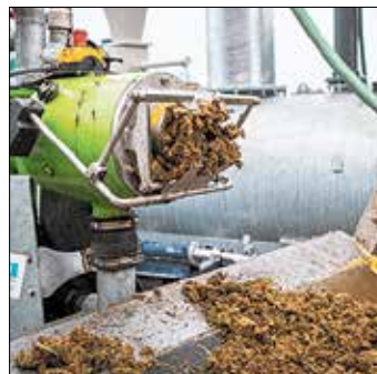
Schneckenpresse (I) und Einbau der Bodenfeuchte-Sensoren in Bergla
