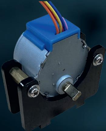
Verschrauben Sie den zweiten schwarzen Acrylrahmen von der anderen Seite mit den beiden Schrauben und Unterlegscheiben. Ihr Schrittmotor kann nun in die Aufnahme auf Ihrem Joy-Pi Advanced aufgesteckt werden.
