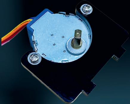
Legen Sie zunächst die erste, schwarze Acrylscheibe auf Ihren Schrittmotor auf und stecken Sie die beiden Schrauben mit den beiden Unterlegscheiben durch die Löcher hindurch.
