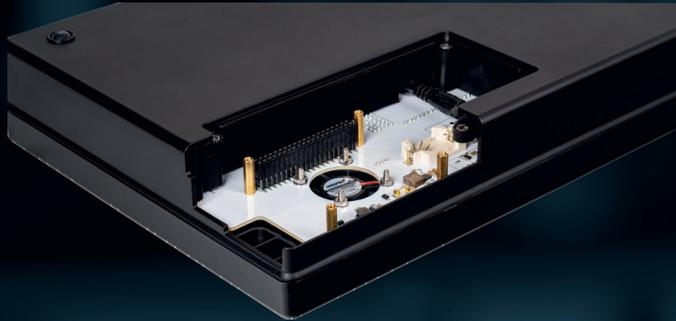
**3** Setzen Sie die beiliegende SD-Karte in Ihren Raspberry Pi ein und schließen Sie die Abdeckung wieder. Ihr Raspberry Pi ist nun vollständig installiert.
