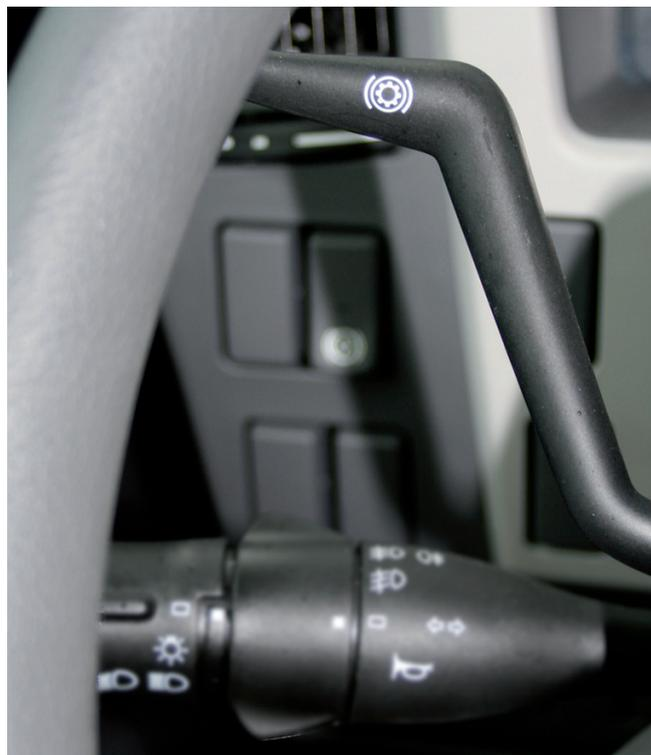
Die Regelung der Bremswirkung erfolgt über den Lenkradhebel.
