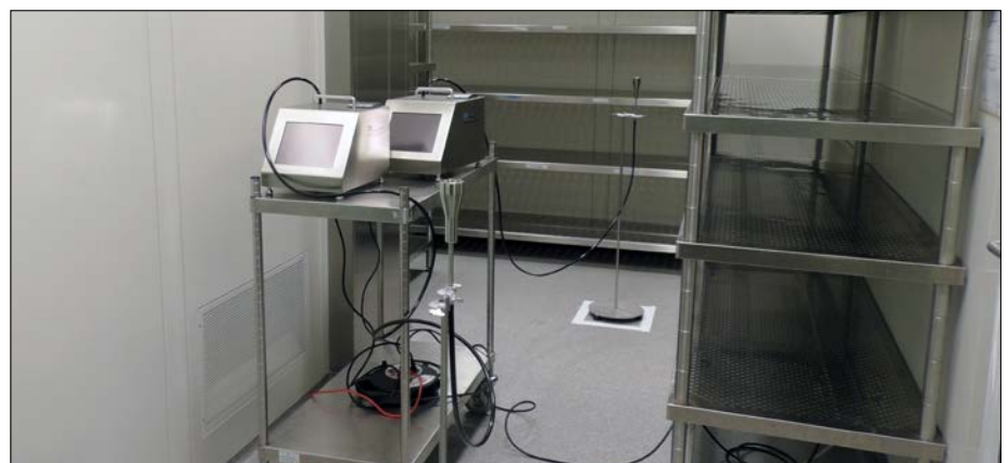
Abbildung 5: Erholzeitmessung in einem Raum mit turbulenter Verdünnungsströmung
