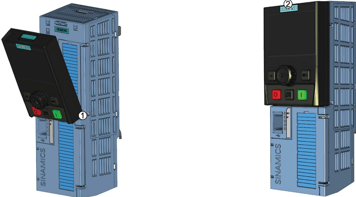
Bild 3-1 Anbringen des IOP an der Control Unit
