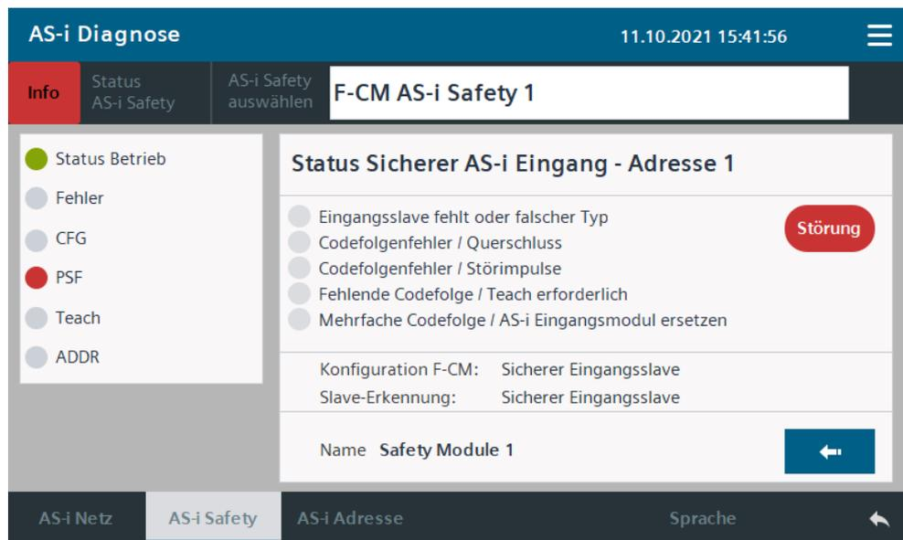
Die Zeile "Konfiguration F-CM" zeigt, welcher Sicherer Slave-Typ im F-CM für die ausgewählte AS-i Adresse konfiguriert wurde. Wenn eine AS-i Adresse ausgewählt wurde, die nicht als Sicherer Eingang oder Ausgang verwendet wird, wird die Information "Kanal nicht verwendet" ausgegeben.
