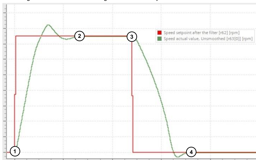
Abbildung 3-9: Trace zur Bestimmung der maximalen Dynamik
