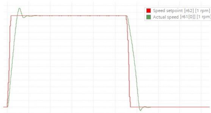
Abbildung 3-5: gut eingestellter Drehzahlregler mit Sprungantwort
