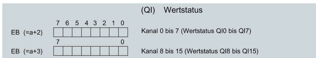
Bild 4-3 Adressraum bei Konfiguration als 16-kanaliges DI 16xNAMUR HF QI mit Wertstatus
