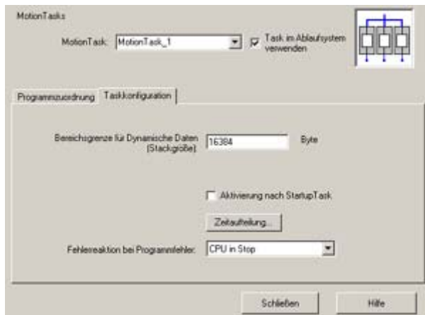
Bild 6-9 Konfiguration von MotionTasks (Taskkonfiguration)
