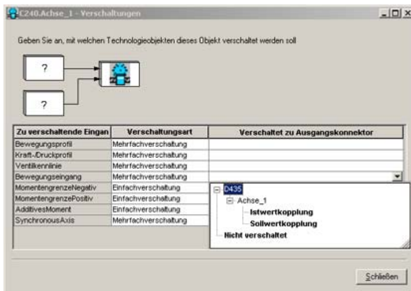
Bild 2-17 Verschaltung im SCOUT - Beispiel Achse
