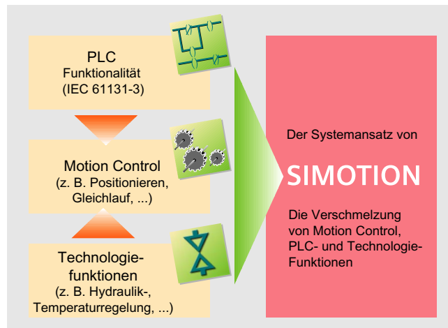
Bild 1-6 Zusammenführung von PLC und Motion Control
