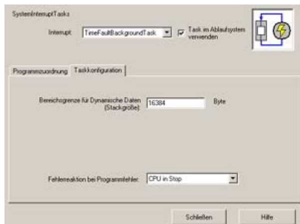
Bild 6-17 Konfiguration der SystemInterruptTasks (Taskkonfiguration)
