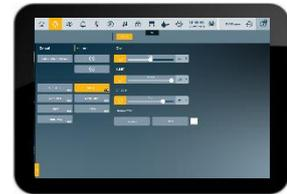
Browser des syneos Industrie-PCs). Optional dazu kann ein mobiles Bediengerät (iPad) eingesetzt werden, das über WLAN mit der Steuerung verbunden ist und so die Bedienung von jedem Punkt in der Kirchenumgebung kontrolliert werden kann. Wird das mobile Panel nicht benutzt, kann es in der Ladestation bei der Bedienstelle parkiert und gesichert werden.
