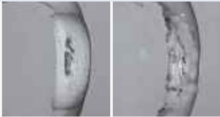
Beispiel einer nicht lötkolbenfesten Bahnleitung Example of a railway cable which is not soldering iron resistant
