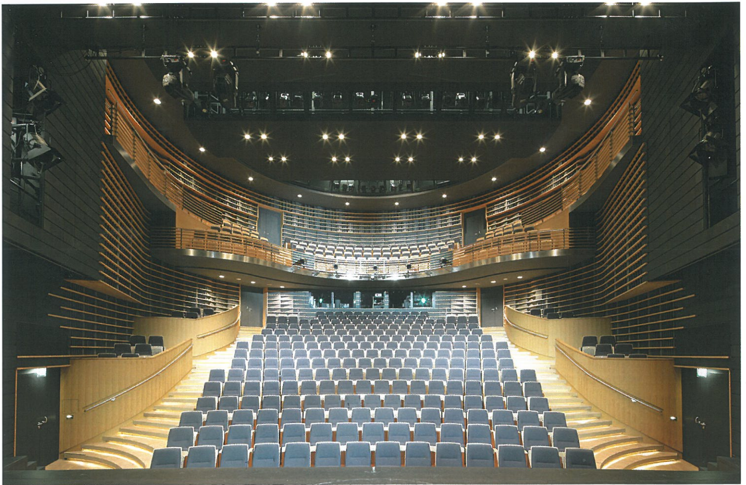
ZENTRALER BLICK IN DEN ZUSCHAUERRAUM: SEITLICHE LOGEN GLIEDERN DEN PARKETTBEREICH, IM HINTEREN SAALBEREICH IST EINE 3-GETEILTE REGIEZONE MIT LICHT UND TONKABINE UND MITTIGER PROJEKTION ANGEORDNET. DER RANG SCHWINGT WEIT AUF BEIDEN SAALSEITEN HERUM.
