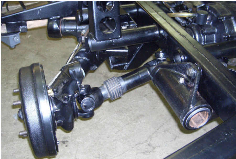
Hinterachsführung und Radantrieb
