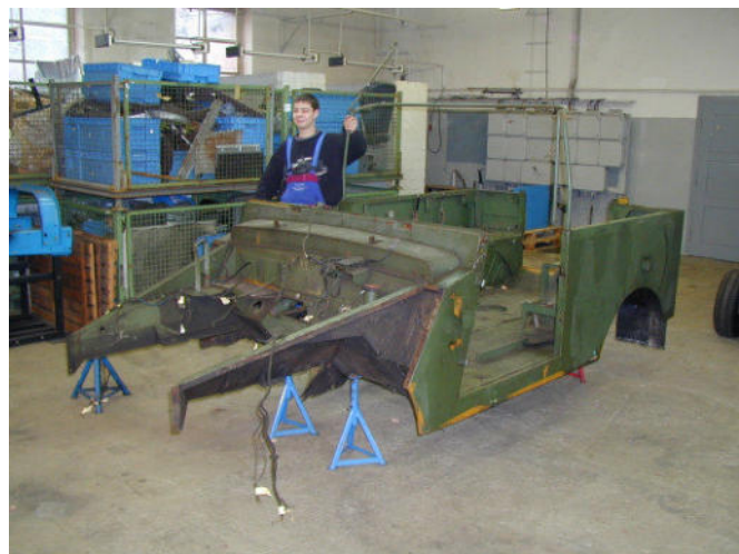
Die abgenommene Karosserie soll erst nach dem Fahrgestell restauriert werden.
