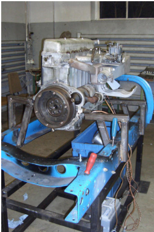
Der Motor bekam ein stabiles Gestell, um Probeläufe durchführen zu können.
