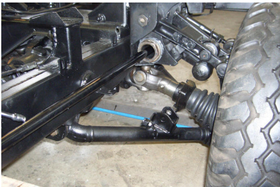
Vorderachsführung und Radantrieb Gut sichtbar der lange Drehstab für die Vorderradfederung
