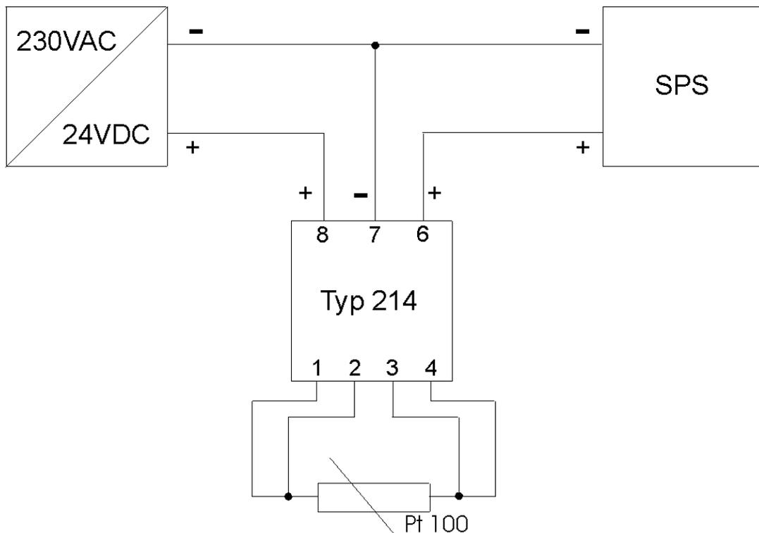
Die Ausgangsspannung folgt linear dem am Eingang anliegenden Temperatursignal. Zwischen dem Sensor und der Versorgungs- bzw. Ausgangsspannung darf keine galvanische Verbindung bestehen.
