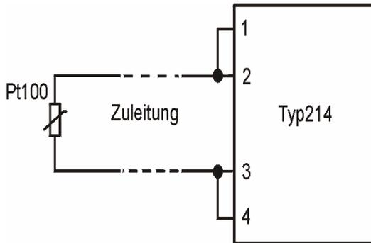
Bei der **Zweileiterschaltung** geht der Widerstand der Zuleitung in das Meßergebnis ein. Deshalb sollte diese Beschaltung nur bei kurzen Leitungslängen oder geringen Genauigkeitsanforderungen gewählt werden.
