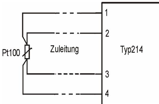
Durch Auftrennung beider Zuleitungen in Strom- und Signalpfad geht der Widerstand der Leitungen bei der **Vierleiterschaltung** nicht in das Meßergebnis ein. Diese Schaltung bietet deshalb die größte Genauigkeit, aber auch den größten Verkabelungsaufwand. Sie ist vor allem bei größerer Entfernung zwischen Sensor und Meßumformer vorzusehen.
