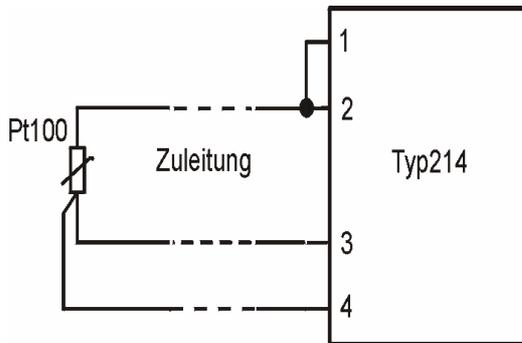
Durch Auftrennung einer Zuleitung in Strom- und Signal-pfad geht der Widerstand der entsprechenden Teilleitung bei der **Dreileiterschaltung** nicht in das Meßergebnis ein. Diese Schaltung stellt einen Kompromiß zwischen der Zwei- und Vierleiterschaltung dar.
