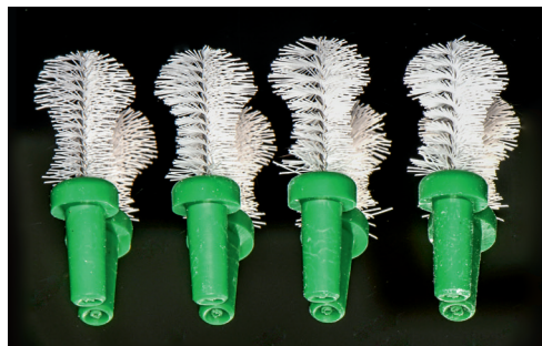
Abb. 2 Testbürsten (Prototypen) mit 200, 250, 300 oder 350 Filamenten.
