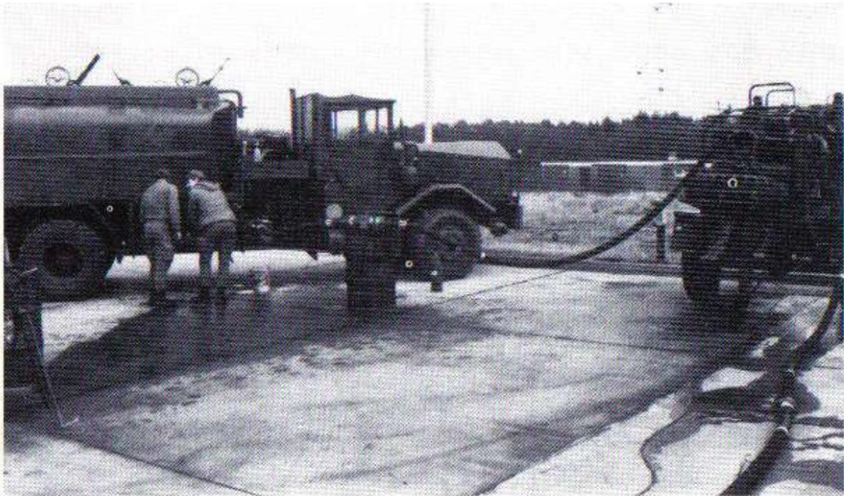
*Befüllung eines Tankkesselwagens (TKW)*
