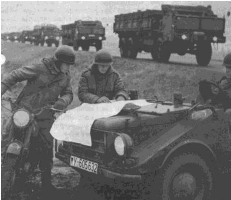
**In den ersten beiden Jahrzehnten gehörte der Faun 908 mit 10 Tonnen Ladekapazität zu den Standardfahrzeugen der Transport- und Nachschubbataillone. In den Jahren 1977/78 wurde er durch den MAN 10 t teilmilitarisiert abgelöst.**
