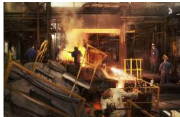
Befüllung der Schleudergussmaschine
