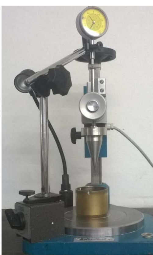
Abb. 1: Fallkegelgerät (links) und Laborflügelsonde (rechts)
