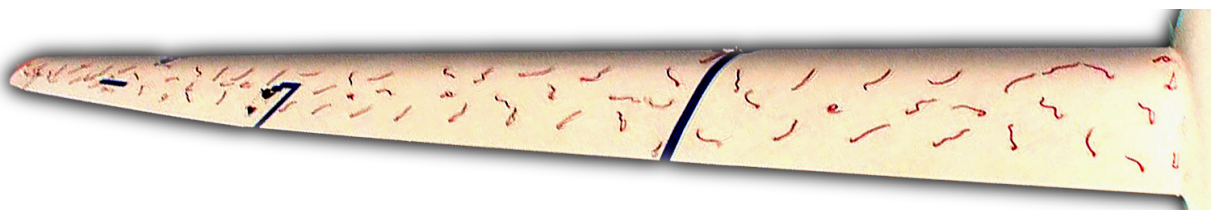
Abbildung 4.10: Strömungsstrukturen bei c_A = 1.17 und Re \approx 0.9 \dots 1.8 \cdot 10^6
