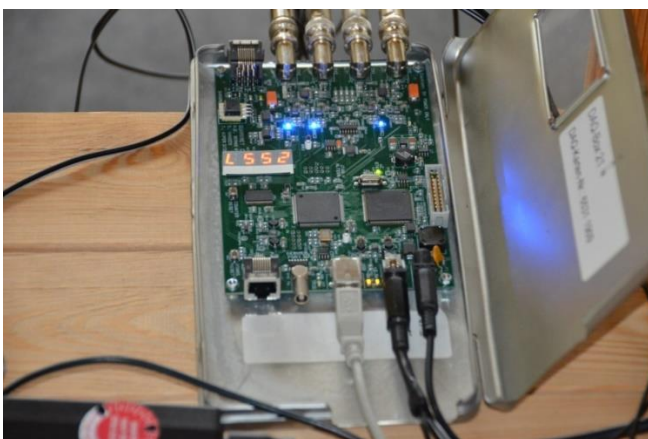
Abb. 19: Aufbau des CosMO-Experimentes im 1. Stock des Andreas-Schubert-Baus (DAQ-Karte [geöffnet])
