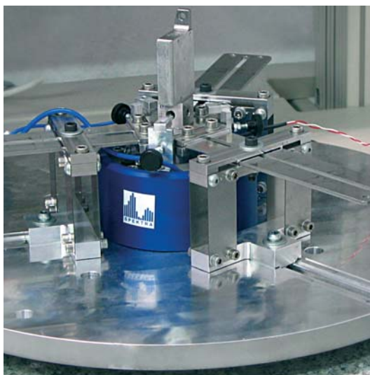
Abb. 3: Prüfling montiert auf dem Schwingungserreger SE-R101 Fotos: SPEKTRA Schwingungstechnik und Akustik GmbH Dresden
