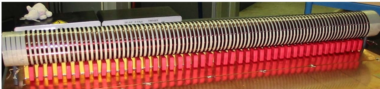
Bild 6.1: Aufgebautes PFN mit 90 Elementen
