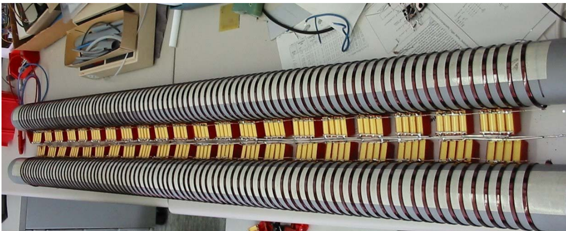
Bild 6.11: Aufbau eines bipolaren PFN-Modells
