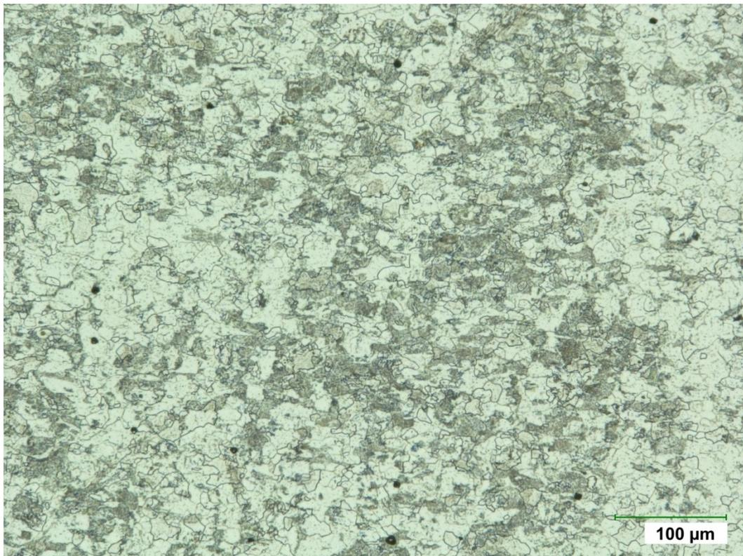
**Abbildung 9:** Gefügestruktur 22MnB5 (500-fache Mikroskop-Vergrößerung)
