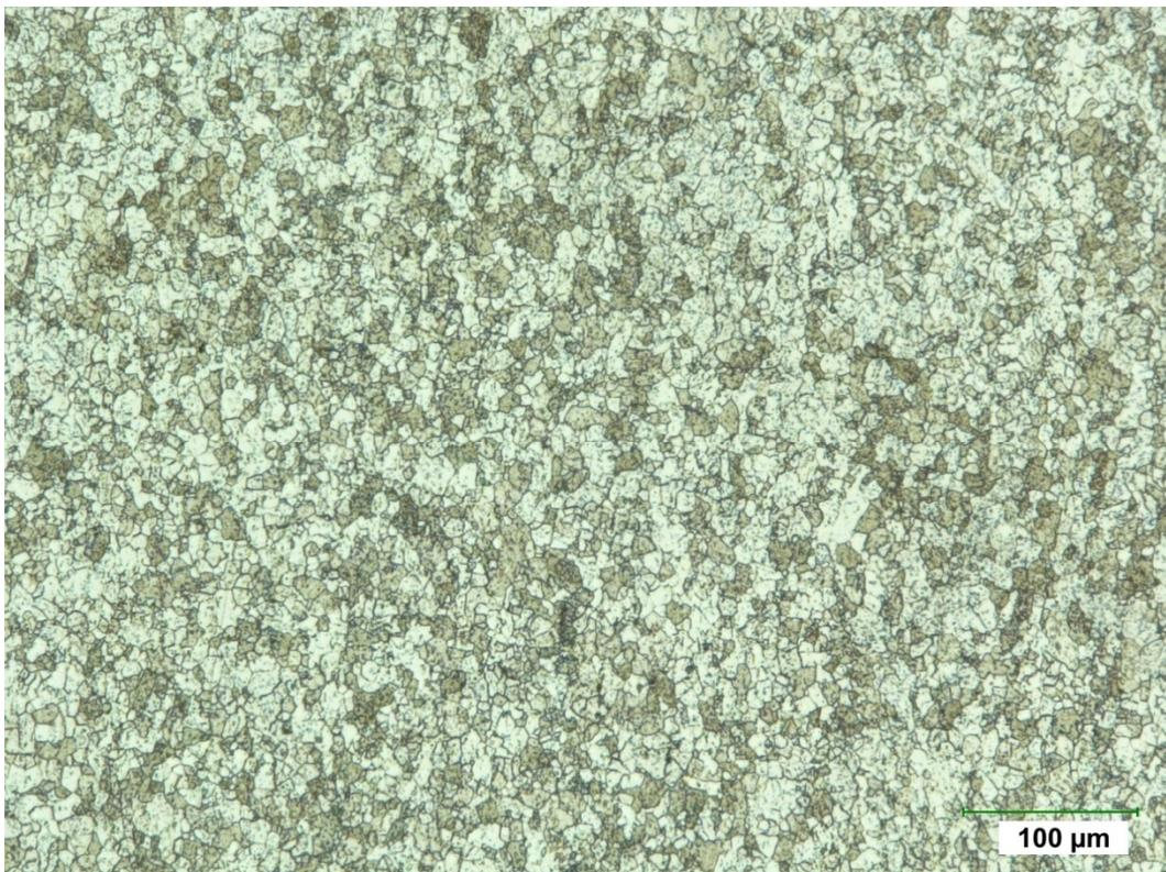
**Abbildung 11:** Gefügestruktur X15Cr13 (500-fache Mikroskop-Vergrößerung)
