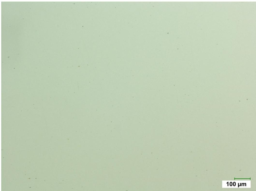
**Abbildung 8:** Nichtmetallische Einschlüsse X15Cr13 (200-fache Mikroskop-Vergrößerung)
