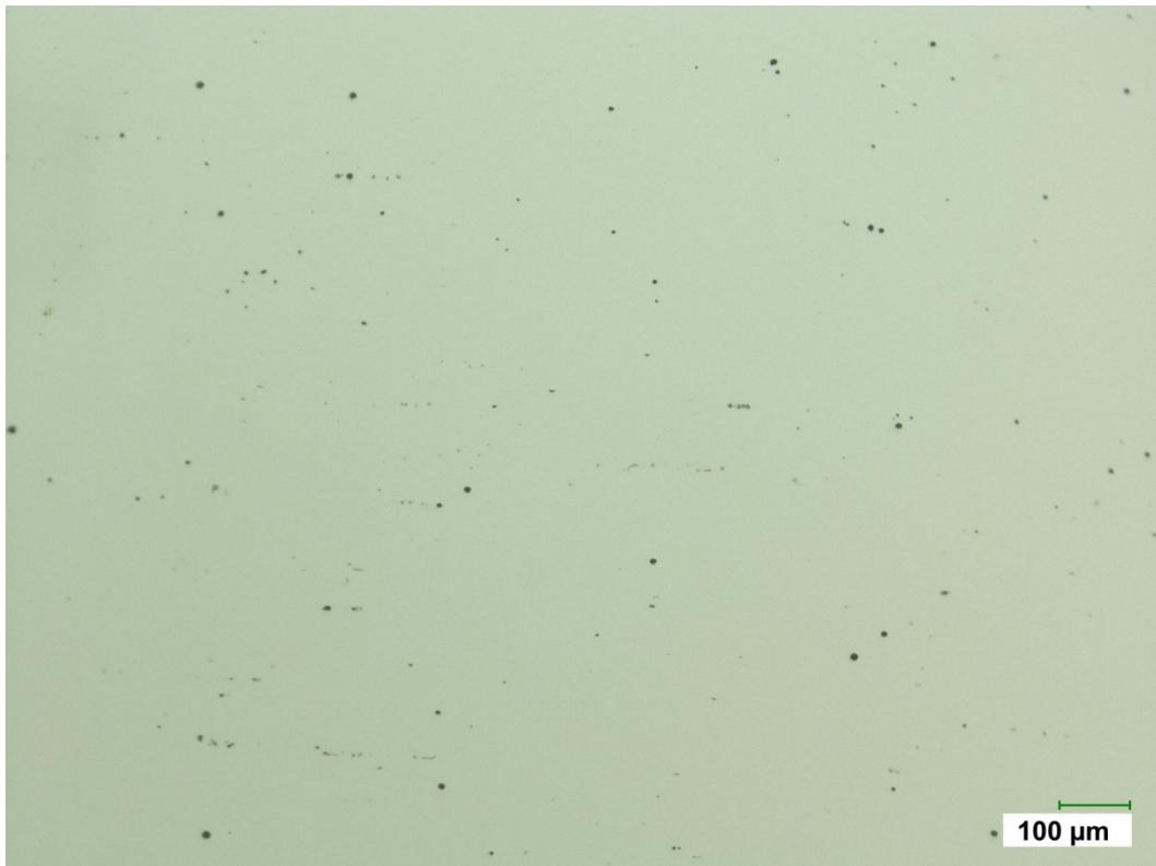
**Abbildung 7:** Nichtmetallische Einschlüsse 22MnB5 (200-fache Mikroskop-Vergrößerung)
