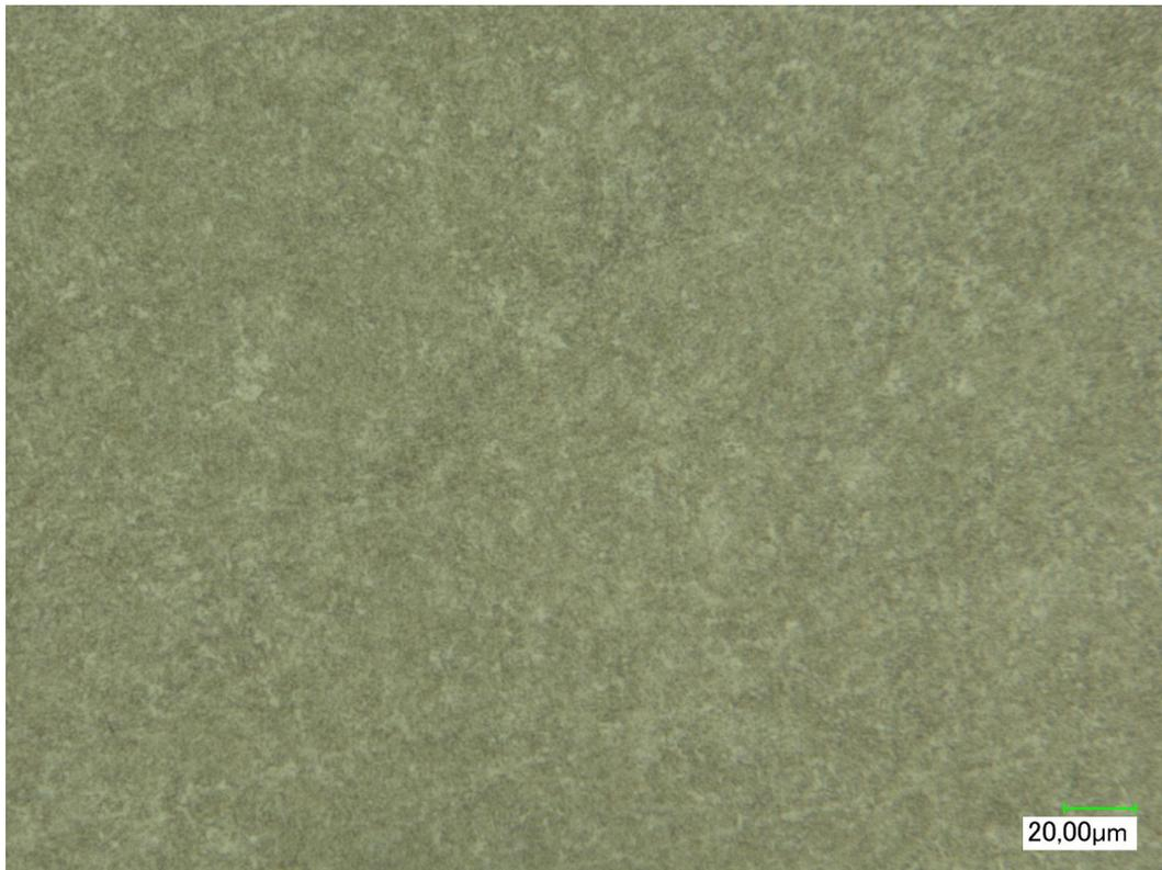
**Abbildung 16:** Schliffbild 22MnB5 575  $\text{Ks}^{-1}$  (alk. Salpetersäure, 1000-fache Mikroskop-Vergrößerung)
