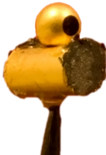
Abbildung 6.1: Prototyp eines Targets für indirekte Energieverlustmessungen. Zu sehen ist der sphärische Konverterhohlraum auf einem zylinderförmigen Sekundärhohlraum, an dessen Öffnungen Kohlenstofffolien angebracht sind. Hergestellt und fotografiert von D. Schumacher.
