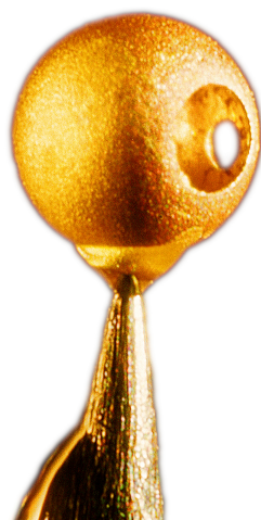
Abbildung 3.3: Ein „Standardhohlraum“ mit 750 \mu\text{m} Durchmesser, der in den Experimenten eingesetzt wurde. Das Diagnostikloch ist durch das Lasereintrittsloch hindurch zu sehen. Fotografiert von A. Zschau.
