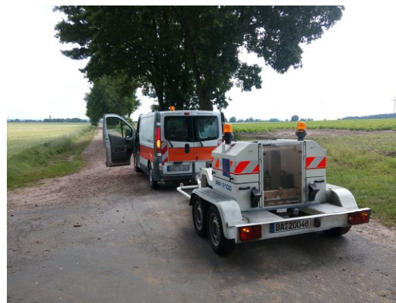
Abbildung 21: FWD im Einsatz auf einer Befestigung im ländlichen Raum (Čičković & Bald, 2017)
