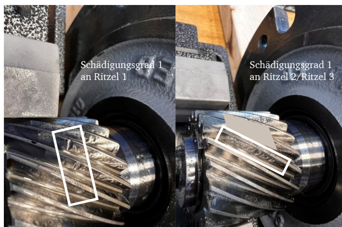
Abbildung 22: Unterschied des Schädigungsgrades 1 in Messreihe 3
