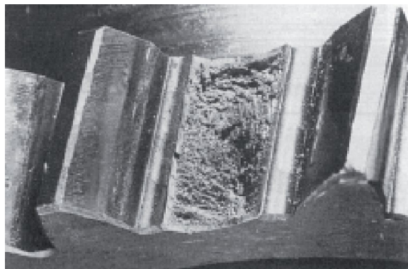
Abbildung 8: Beispiel des Schadensfalls Gewaltbruch [Klocke & Brecher, 2017, S. 385]
