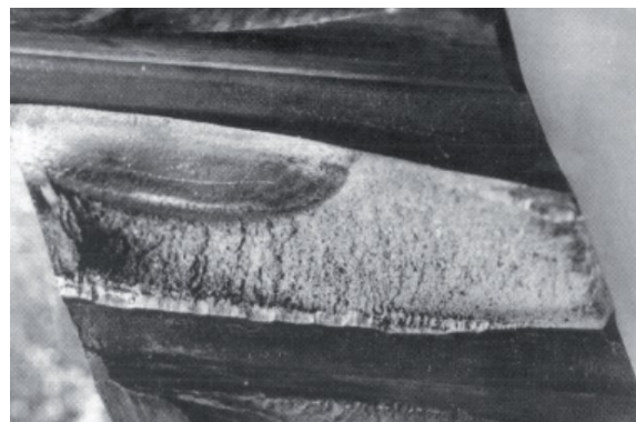
Abbildung 9: Beispiel des Schadensfalls Dauerbruch [Klocke & Brecher, 2017, S. 386]
