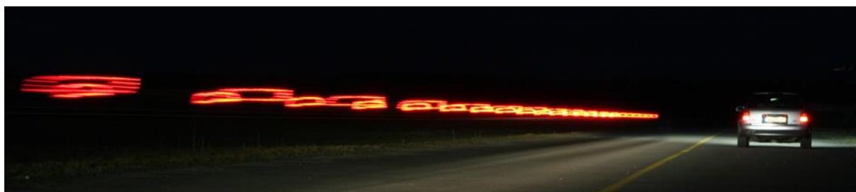
Abbildung 3.7: Perlschnureffekt bei PWM-gedimmten LED-Heckleuchten aus [48]
