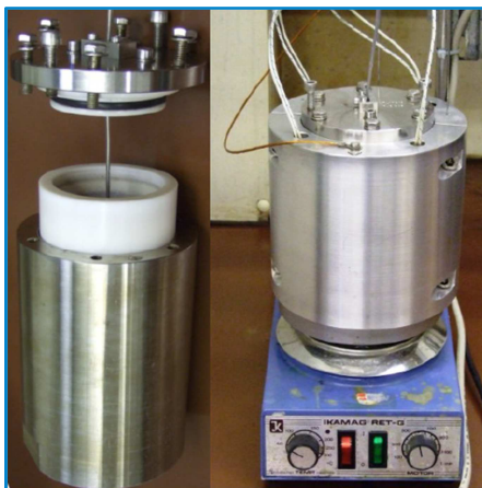
Abb. 4-1: Hydrothermalreaktor. Links: Geöffneter Druckbehälter mit herausgezogenem PTFE-Einsatz und Deckel. Rechts: Vollständig montierter Hydrothermalreaktor mit Heizmantel und Rührplatte. [Jek2012b]
