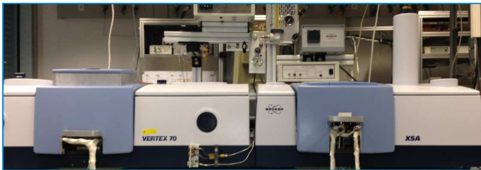
Abb. 4-2: IR-Spektrometer VERTEX 70 der Firma Bruker. Mit externem Probenraum XSA und MCT-Detektor.
