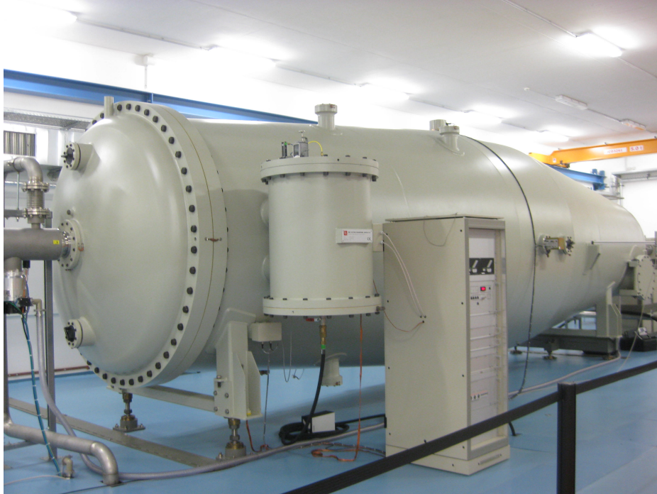
Abbildung 2.13.: Tank des 6 MV Tandatron Beschleunigers am Ionenstrahlzentrum des Helmholtz-Zentrums Dresden-Rossendorf.
