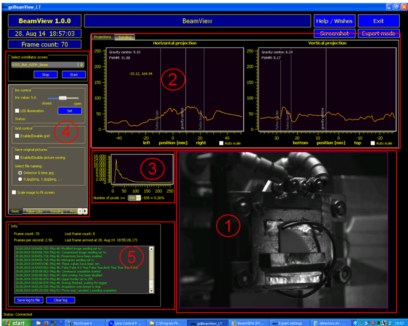
Abbildung 3.5.: Screenshot des zur Datenakquise verwendeten Programms Beamview . (1) Bild, (2) horizontale und vertikale Projektion des Bildes, (3) Histogramm (4) Fenster zum Starten und Beenden der Messung sowie zum Speichern der Bilder, (5) Log-Fenster, indem alle vorgenommenen Änderungen angezeigt werden.
