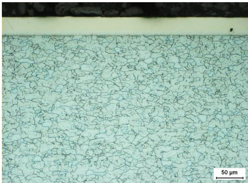
Abbildung 59: Mit Nital geätzter Querschliff eines vernickelten H480LA-Blech
