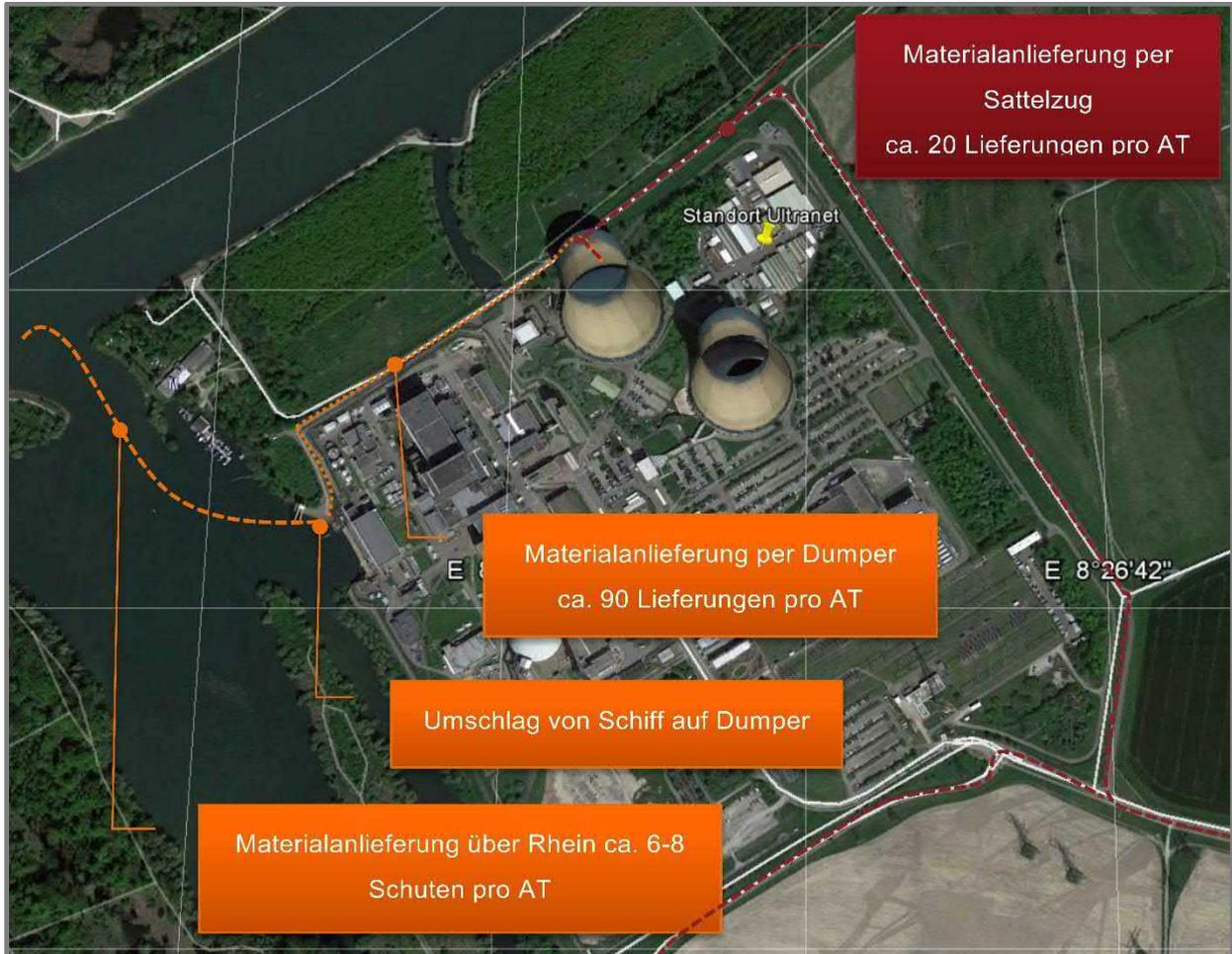
**Abbildung 14: Darstellung der Transportwege zur Auffüllung des Konvertergeländes**
