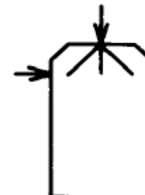
Sprühtrockner mit Zuführung der Warmluft
