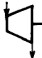
Antriebsmaschine mit Expansion des Arbeitsstoffes, Turbine
