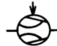
Strahlverdichter mit Zuführung des Treibmediums
