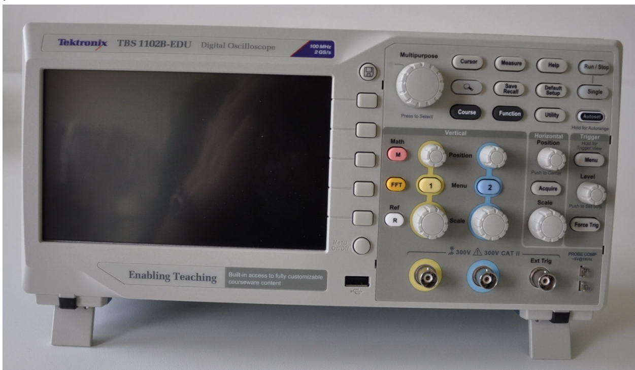
Abb. 1: Frontansicht des im Praktikum eingesetzten Digital-Oszilloskops TEKTRONIX TBS 1102EDU.
