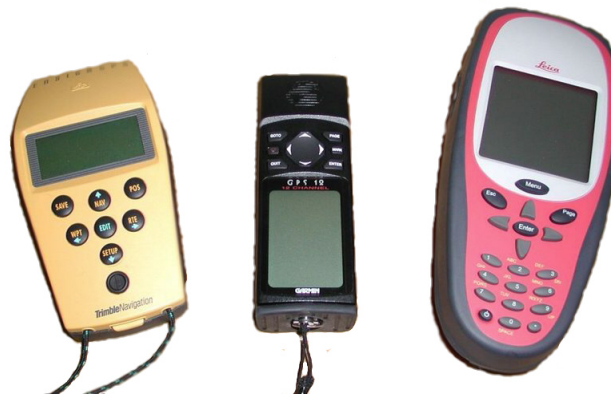
Abbildung 3.5: Beispiele für GPS Empfangsgeräte von Trimble, Garmin und Leica
