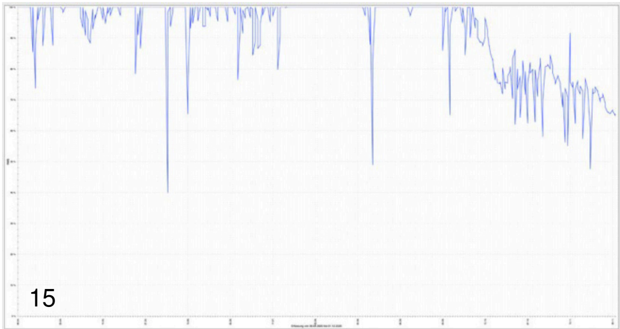
Abb. 1: Verlauf der Mikrofonempfindlichkeit während des Erfassungszeitraums für die Detektoren auf den WEA (Nummer der WEA in der Abbildung angegeben). Dargestellt ist der Schalldruckpegel des täglich abgespielten Testsignals als blaue Linie (RootMeanSquare-Wert). Horizontale grüne Linien oben und unten geben den Toleranzbereich von \pm 6 dB um den ursprünglich kalibrierten Referenzwert (mittlere horizontale rote Linie) an. Werte unterhalb der roten Linie geben eine geringere, Werte über der roten Linie eine höhere Empfindlichkeit des Mikrofons relativ zum ursprüngliche kalibrierten Wert an. Wo die theoretische Obergrenze des Toleranzbereichs das Maximum des Dynamikbereichs übersteigt, ist keine sinnvolle Messung möglich. In diesem Fall wird hier die obere grüne Linie nicht angegeben. Für gültige Messungen muss das Testsignal zwischen der oberen und der unteren grünen Linie liegen (bzw. zwischen der Oberkante der Darstellung und der unteren grünen Linie). Liegt die Empfindlichkeit länger als drei Tage in Folge außerhalb des Toleranzbereiches, sollte das Mikrofon getauscht werden.
