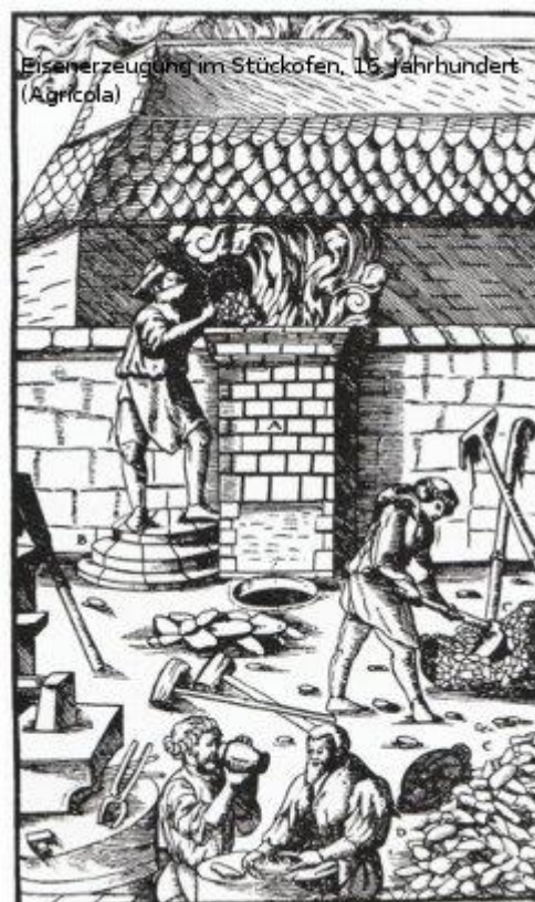
Abbildung 3: Eisenerzeugung im Stückofen, 16. Jahrhundert.
