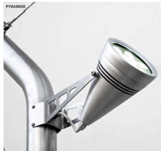
Faretto per esterno composto da 9 LED, realizzato in alluminio e con accessoriata in acciaio inox. Elegante e versatile, può essere utilizzato per l'illuminazione di Pergotenda® o installato su tutte le vele della collezione Velombra. 230 Volt. Assorbimento 10 W.
