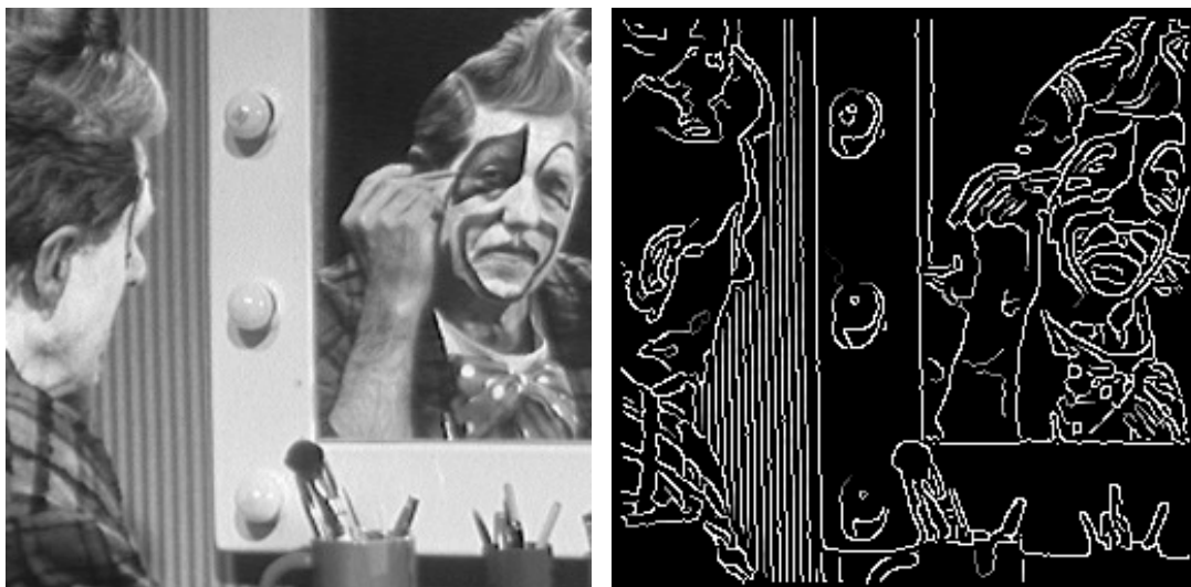
(a) Grauwertbild eines sich schminkenden Clowns (b) Grauwertbild eines sich schminkenden Clowns nach der Anwendung von Canny (1.0,255,1)
