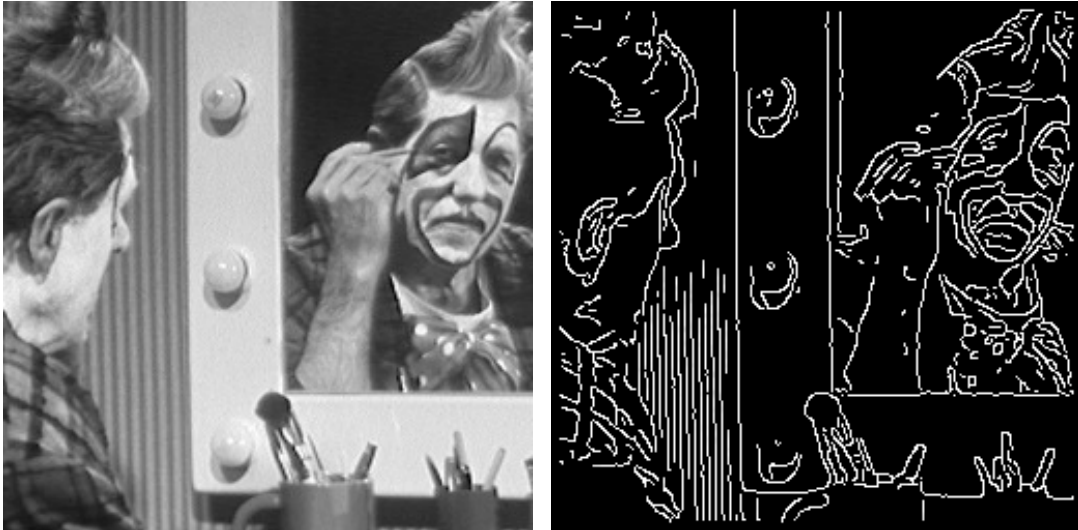
(a) Grauwertbild eines sich schminkenden Clowns (b) Grauwertbild eines sich schminkenden Clowns nach der Anwendung von Canny(1.0,255,220)
