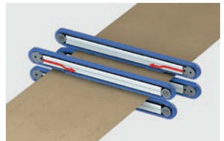
Abb. 4: Anhebung der Bürsten im Kantenbereich
