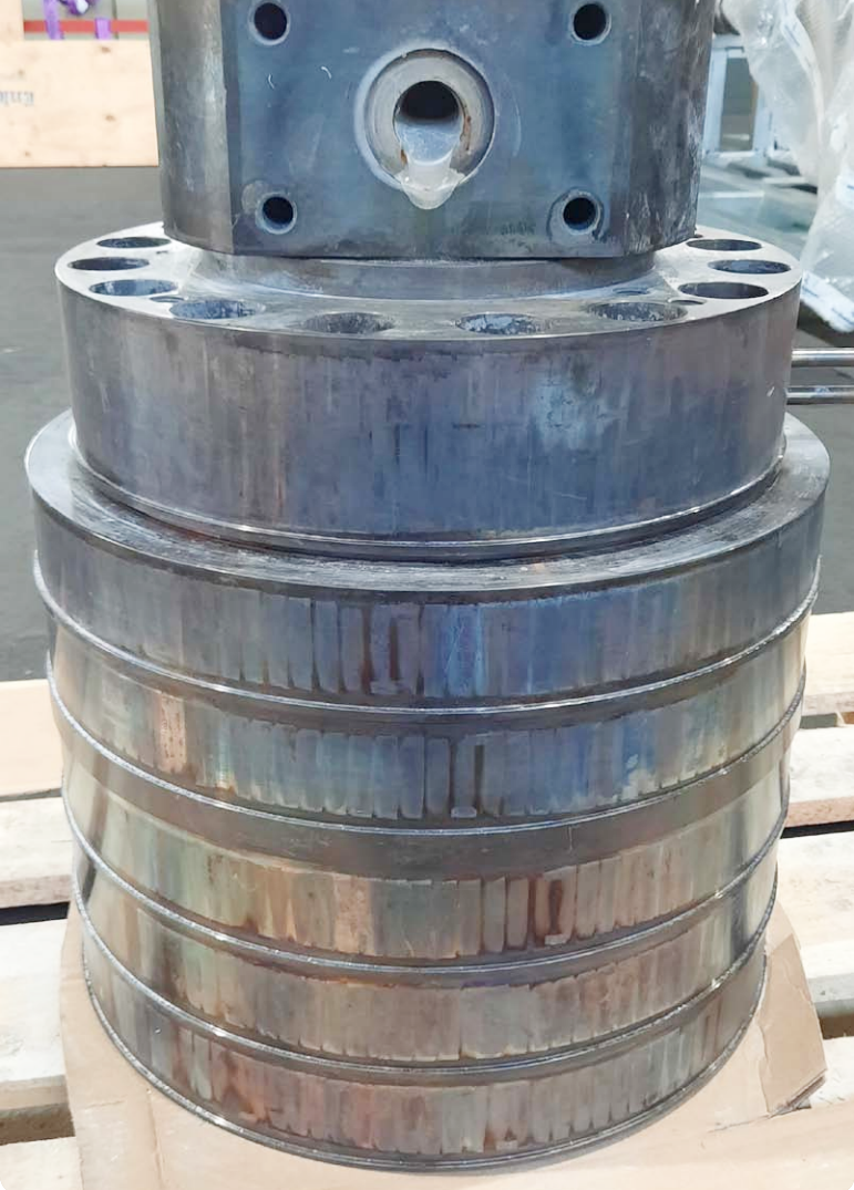
Unzerlegter Blaskopf mit Polyolefinresten vor der thermischen Reinigung in einer automatischen Vakuumpyrolyse-Anlage. (Bild: Schwing)
