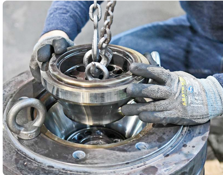
Nach der Reinigung lassen sich die Komponenten des Blaskopfs einfach und beschädigungsfrei demontieren. (Bild: Schwing)
