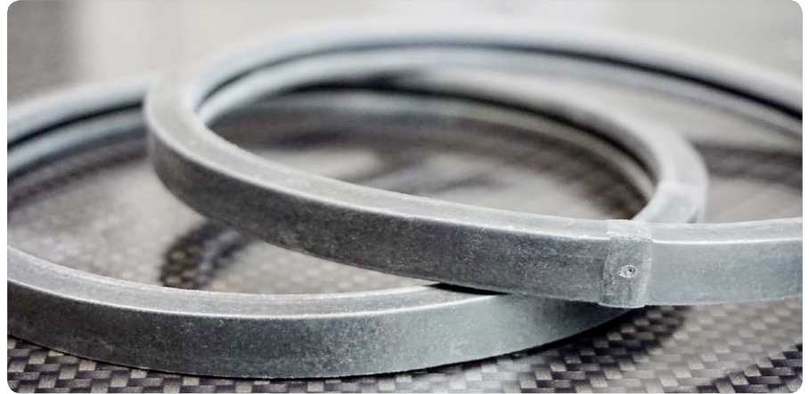
EDPM-Dichtung aus extrudierter Meterware erhält per Stoßvulkanisation statt verklebter Verbindung deutlich bessere Eigenschaften. (Bild: Kremer)
