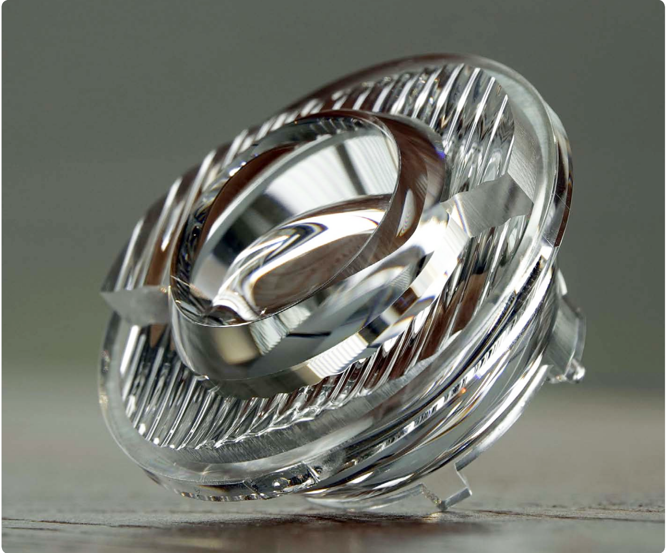
Die im Spritzgießverfahren produzierten Linsen bieten hohe Transparenz und Lichtleitfähigkeit sowie sehr geringe Toleranzen. (Bild: Lupine)
