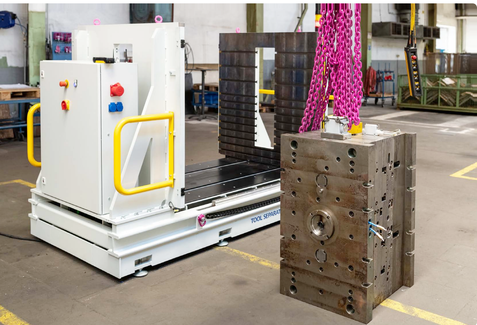
Das Öffnen von Werkzeugen geschieht ergonomisch, sicher und schonend mit spezialisierter Technik. (Bild: Rud)
