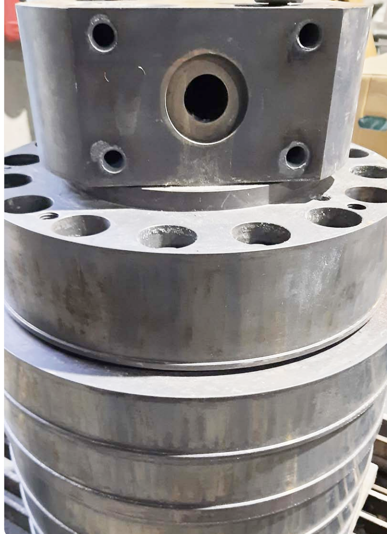
Blaskopf nach der thermischen Reinigung – dazu wird der Blaskopf erhitzt, der Kunststoff durch Pyrolyse zersetzt und unter sukzessiver Zugabe von Sauerstoff oxidiert. (Bild: Schwing)
