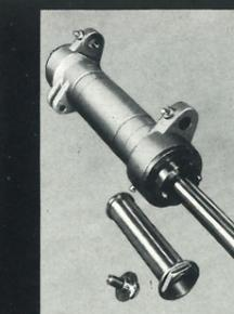
4-fach kugelgelagerte Sägewelle aus Spezialstahl mit Aufsteckbüchse für Schnellwerkzeugwechsel
