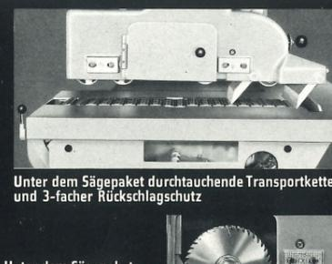
Unter dem Sägepaket durchtauchende Transportkette und 3-facher Rückschlagschutz
