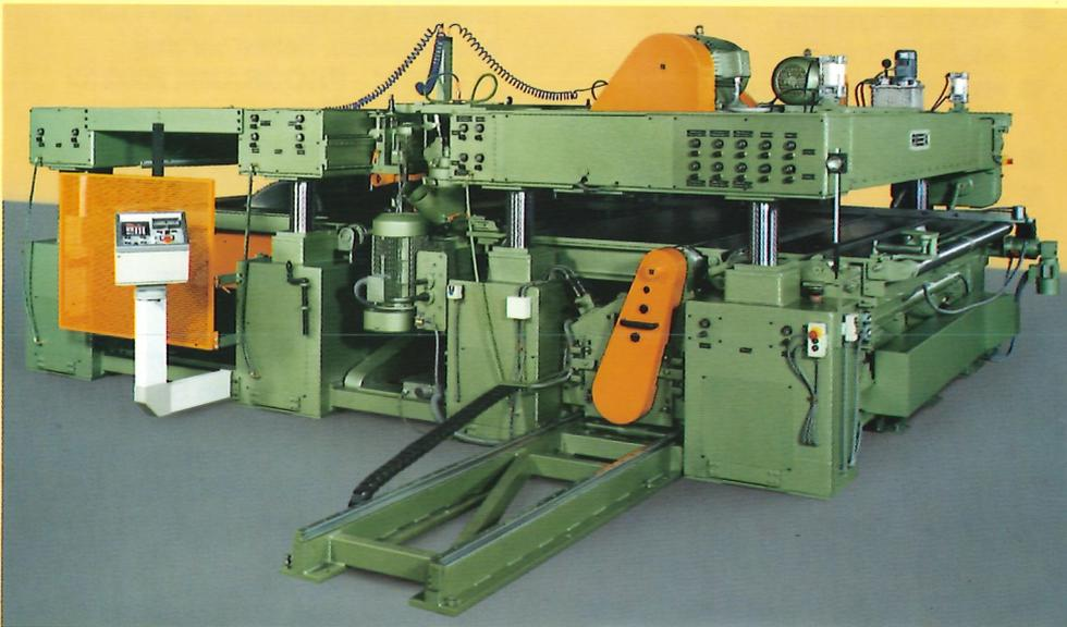
◀ Schwere Hochleistungs-Breithobelmaschine HOMS-2600, mit 2600 mm Arbeitsbreite, oszillierenden Wellen und integrierter BS Holz-Auftrennsäge. Werkzeug-Schnellwechselsystem REX - Mobil/2000.
